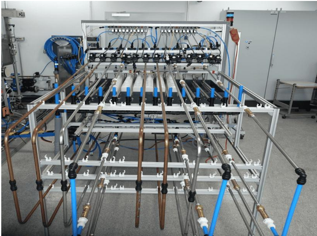
Abbildung 6. Korrosionsprüfstand gemäß DIN EN 15664-1 des TZW, Karlsruhe.
